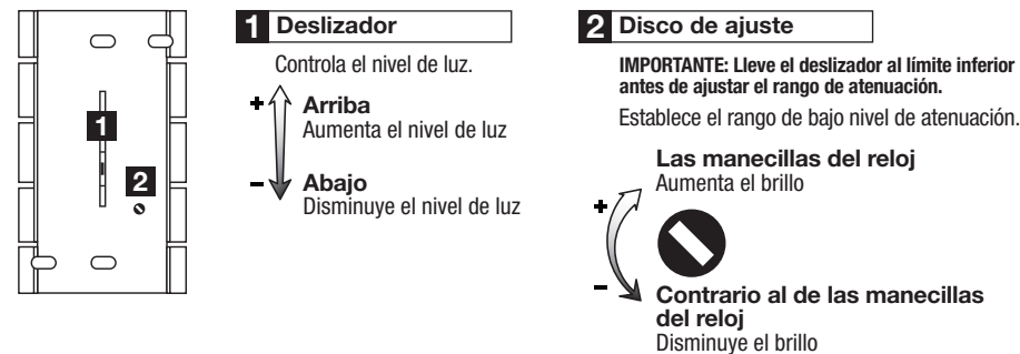
Figura 1: Características del atenuador
